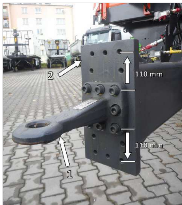
Rys. 22 Regulacja oczka pociągowego
