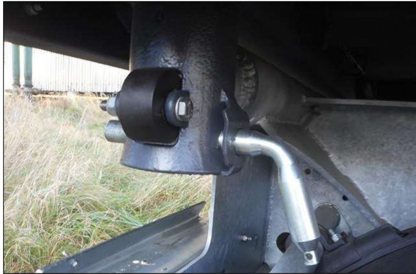
Rys. 17 - Zabezpieczony sworzeń wywrotu.
